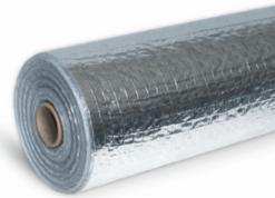
Folie paroizolacyjne są stosowane w pomieszczeniach jako ochrona konstrukcji dachu i izolacja termiczna przed wilgocią z wnętrza budynku. Folie paroizolacyjne są instalowane od wewnętrz, pomiędzy izolacją termiczną a płytą styropianową, dzięki czemu para nie dostaje się do konstrukcji dachu lub ścian.
