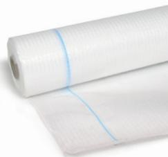
Folie niskoparoprzepuszczalne (nazywane foliami wstępniego krycia) uszczelniają pokrycia dachów pochyłych ochraniając je przed podlewianym deszczem lub śniegiem oraz przed skroplinami gromadzącymi się pod pokryciami zasadniczymi. W dachach wentylowych o poddaszu mieszkalnym muszą być oddzielone od termoizolacji szczelestą, a na styczach przestrzenią wentylacyjną.
