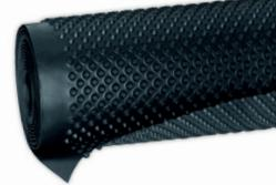
Folie IZOFLEX stosowane są do izolacji przeciwwilgociowej fundamentów, tarasów, stropów, stropodachów i podłóg. Dzięki wytłoczeniom tworzą szczelinę umożliwiającą dodatkowo wentylację izolowanych powierzchni. Odporność na kwasy znajdującej się w glebie, kwasy nieorganiczne, wodę. Szybkie i skuteczne odprowadzenie wody do systemu drenażowego. Zapewnia optymalną przestrzeń wentylacyjną. Zwiększa izolację termiczną ścian i fundamentów.
